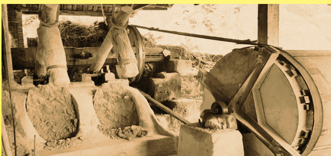
Macchine di produzione tradizionale (水碓 shui dui) per la produzione di polveri utilizzate per la fabbricazione di porcellana elettrica (collezione privata)
