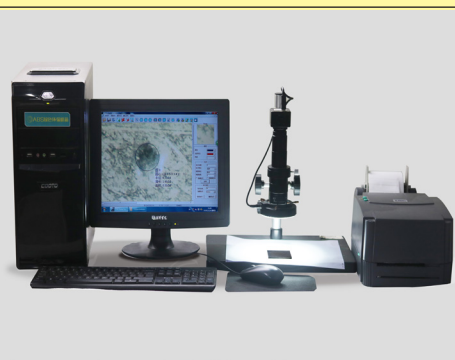
Misurazione al microscopio elettronico del diametro dell'impronta (Laboratorio Ultimheat)
