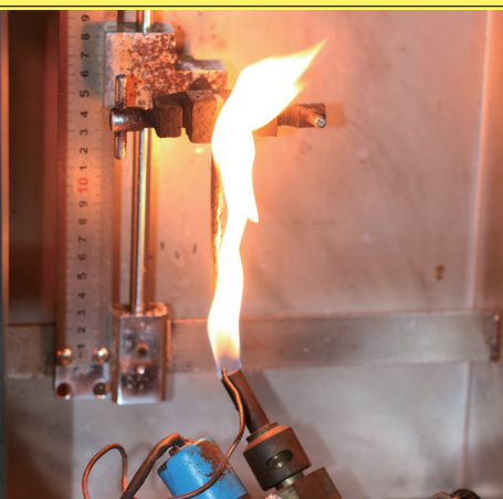
Campione durante il controllo UL94VO
